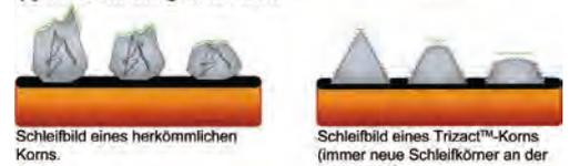
**Herkömmliche Schleifkörner im Vergleich zu pyramidenförmigen Schleifkörnern:**
