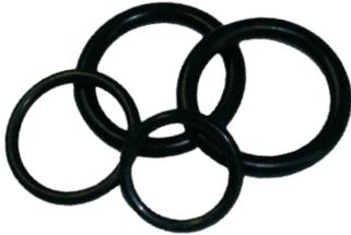
O-Ringe sind endlos gefertigte Ringe mit kreisrundem Querschnitt. Bei Einbau und Verpressung im Einbauraum wird der Querschnitt deformiert. Dadurch entsteht die Dichtwirkung. Die Verpressung kann radial oder axial erfolgen. Der Druck des Mediums verstärkt im Betriebszustand die Dichtfunktion zusätzlich.
